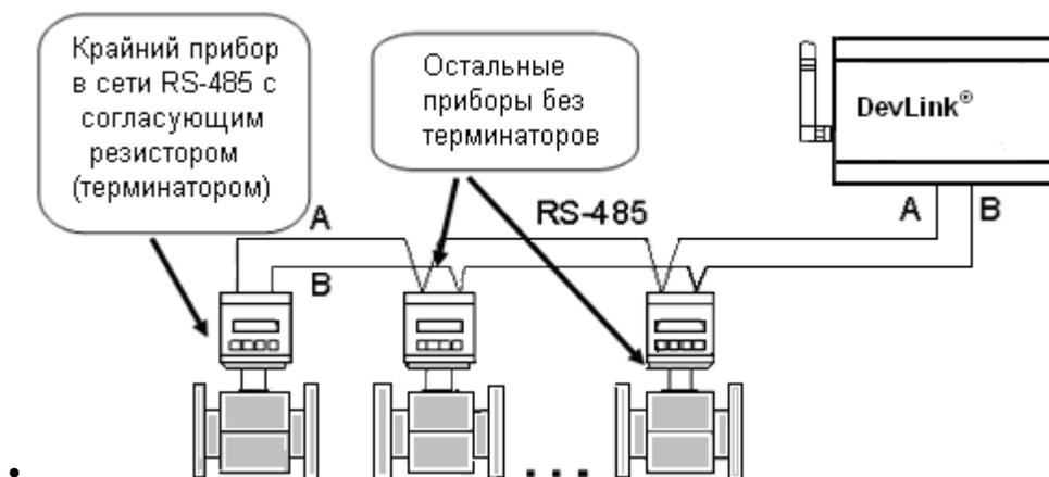
Рисунок 17 – Пример подключения к контроллеру DevLink® сети RS-485
