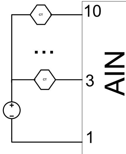
Рисунок 15 – Схема подключения аналоговых сигналов 4-20мА
