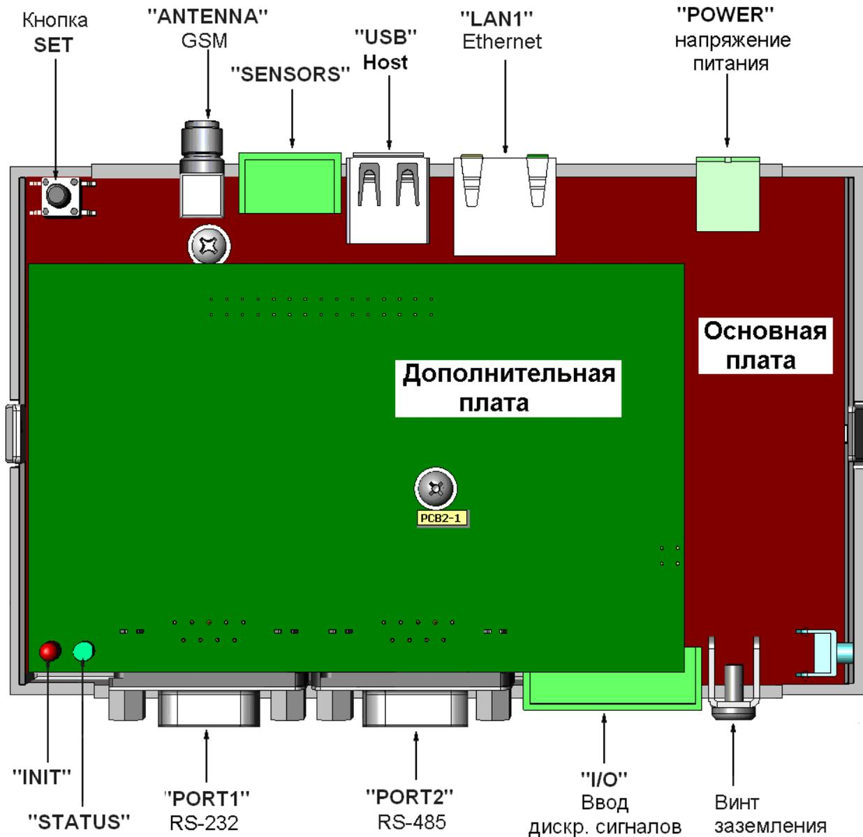
Рисунок 11 – Двухплатный вариант №1 электронного блока DevLink®
