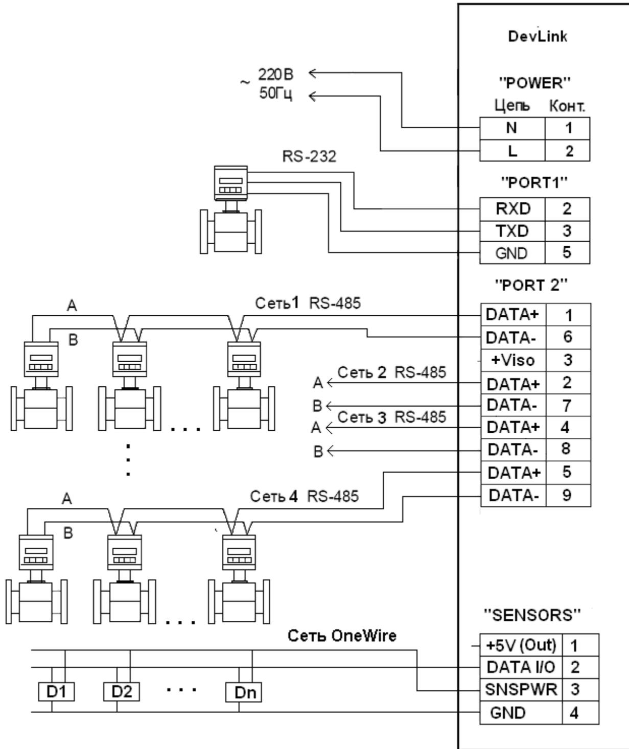
Рисунок П 1.2 - Пример подключения к двухплатному **DevLink**<sup>®</sup> приборов с интерфейсами RS-232, RS485, OneWire
