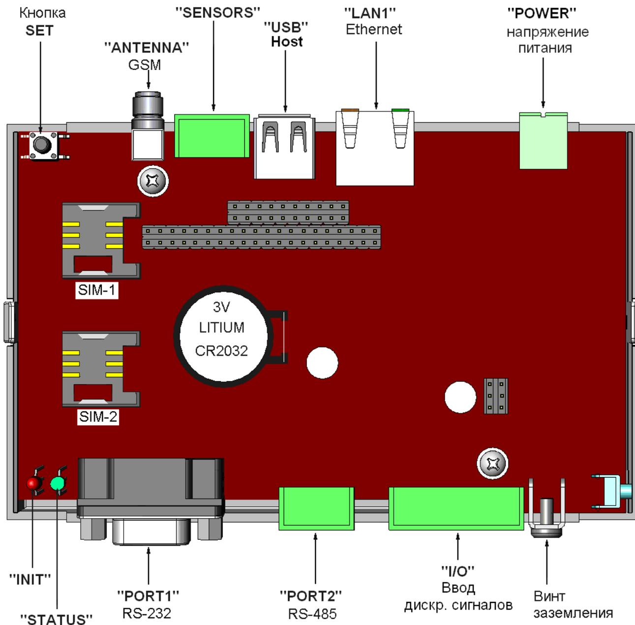
Рисунок 3 – Одноплатный вариант электронного блока DevLink®
